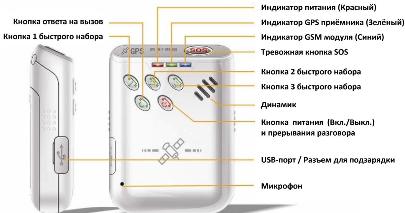
На внешней панели трекера P-008 размещены три светодиодных индикатора разных цветов и несколько кнопок. При включении устройства все индикаторы активированы. Короткое нажатие кнопки SOS позволяет включать и выключать индикаторы GPS и GSM модулей, а также подсветку клавиатуры.
