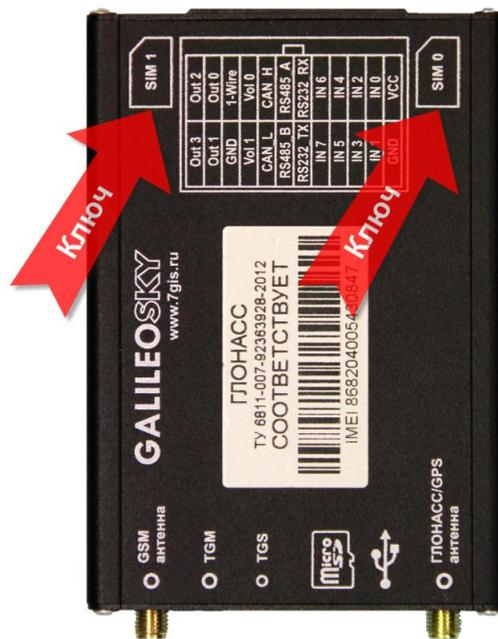
Рисунок 9. Схема установки SIM-карты
