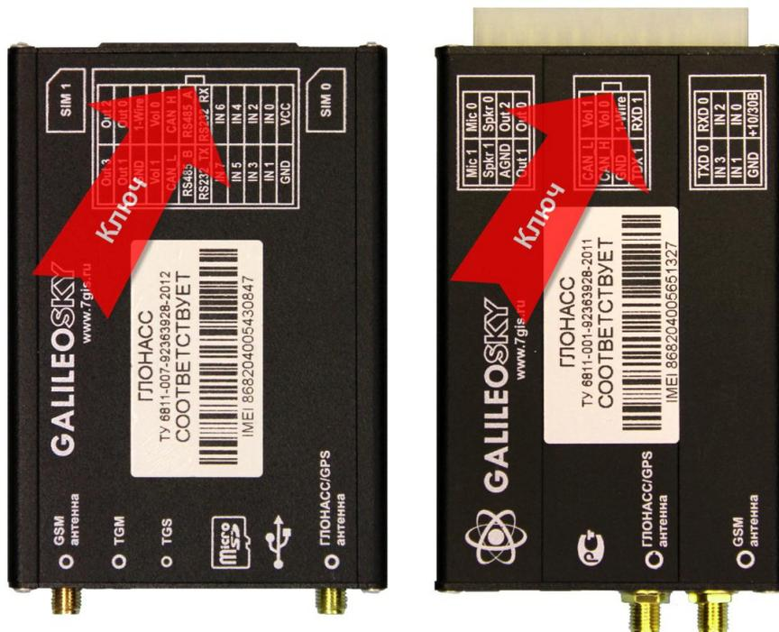
Рисунок 4. Схема расположения контактов
