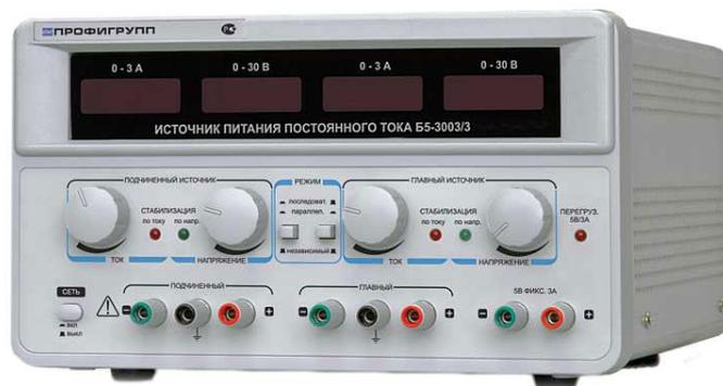
Рисунок 1. Двухканальный источник электропитания
