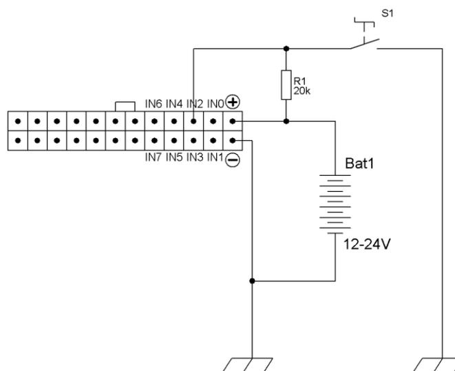
Рисунок 8. . Схема подключения ТК с замыканием на "массу"
