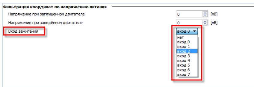
Рисунок 14. Настройка датчика зажигания на фильтрацию координат
