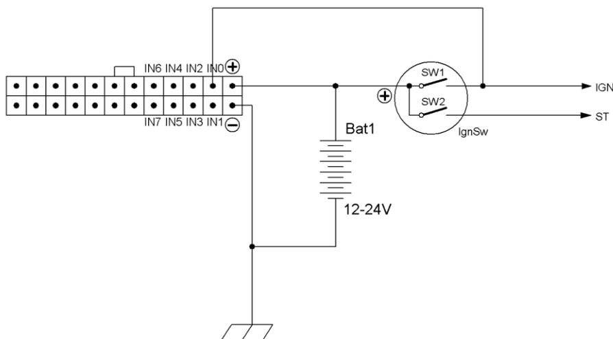
Рисунок 13. Подключение датчика зажигания
