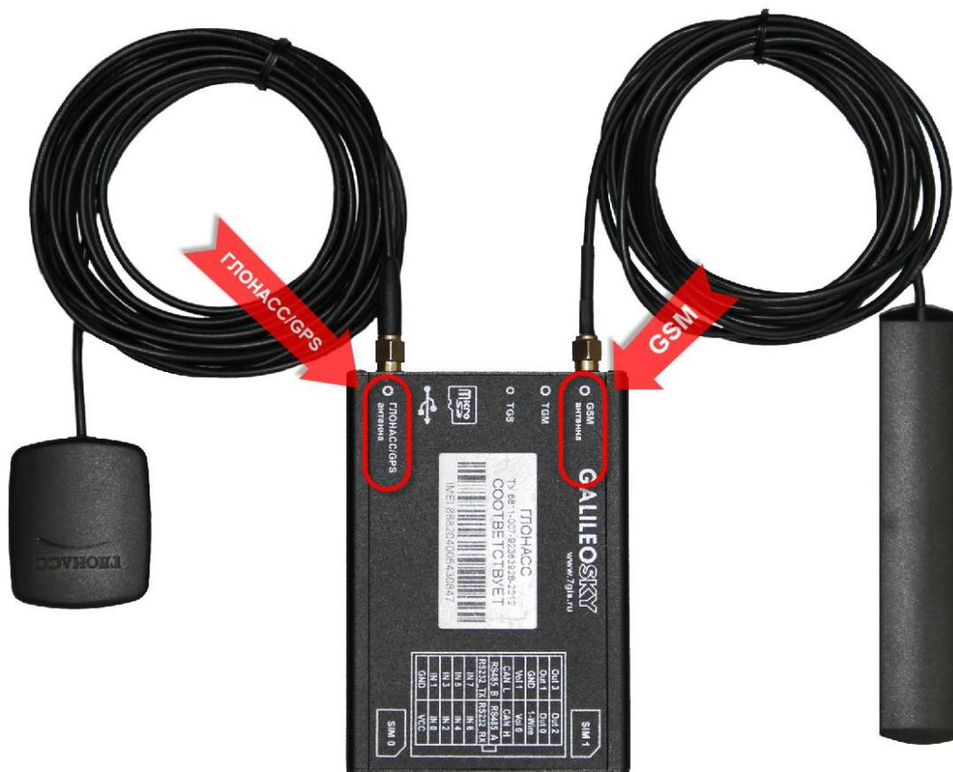
Рисунок 12. Подключение ГЛОНАСС/GPS-антенн
