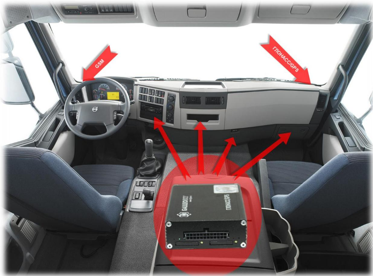
Рисунок 16. Варианты размещения терминала GALILEOSKY
