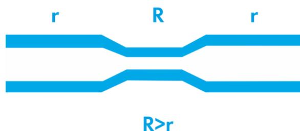
При использовании подобных некачественных проводов в месте растяжки на участке R повышается сопротивление и, как следствие, возникает повышенное тепловыделение и падение напряжения, что может привести к снижению напряжения питания терминала ниже допустимого или короткому замыканию в случае расплавления защитной оболочки провода.
