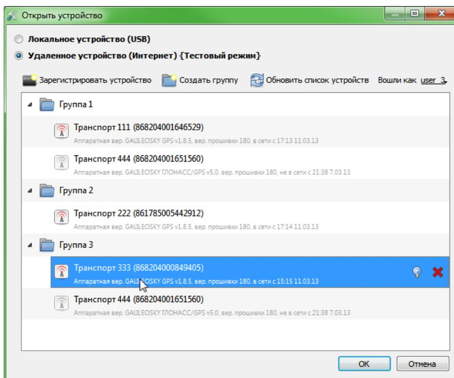
После выбора конкретного Терминала, им можно управлять через Конфигуратор, аналогично тому как происходит с подключением по USB.
