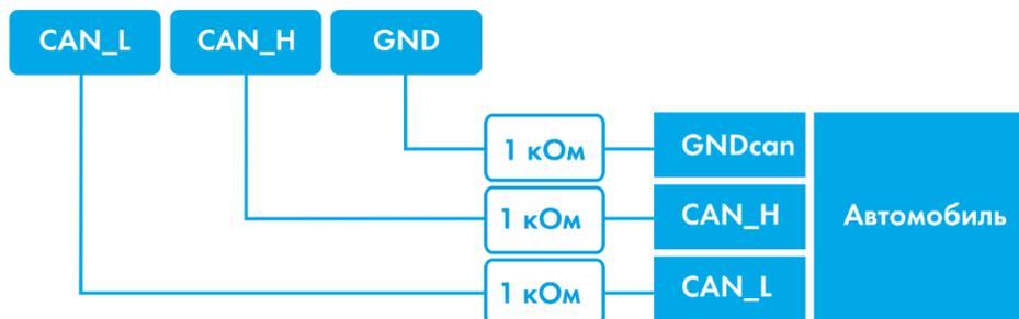
Для включения Терминала в диагностический разъем необходимо использовать первый вариант. Для включения Терминала непосредственно в бортовую шину CAN рекомендуем использовать только второй вариант подключения.
