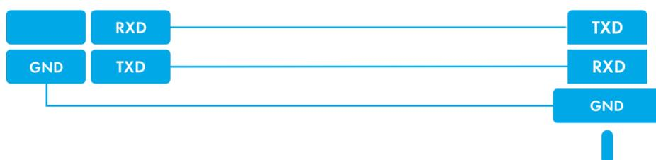
2. Настроить для канала RS232 Терминала получение условного уровня топлива или частоты с датчика. Это можно сделать, пошлав команду RS2320 (раздел [Настройка цифровых входов](#)) или через Конфигуратор на вкладке «Настройки»/«Цифровые входы». По умолчанию порт RS232 Терминала настроен на получение условного уровня топлива.
