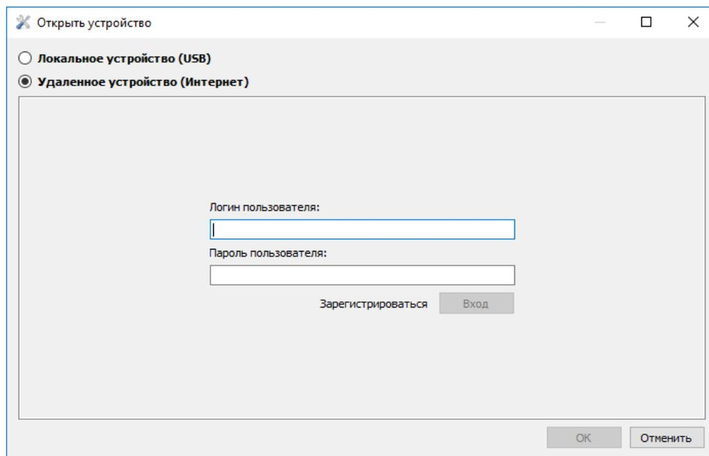
После успешной авторизации на сервере, будет доступна форма управления списком терминалов. При первом подключении список контролируемых терминалов будет пуст. Для добавления Терминала в список необходимо воспользоваться кнопкой «Зарегистрировать устройство». При регистрации Конфигуратор запросит пароль для конкретного Терминала, заводской пароль соответствует IMEI'ю Терминала, в дальнейшем пользователь может изменить его через Конфигуратор. Терминалы могут быть объединены в группы.
