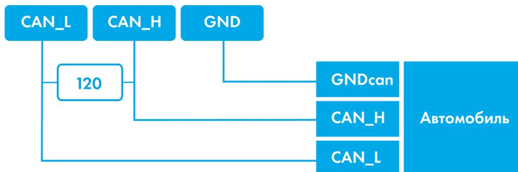
**ВНИМАНИЕ!** Если законцовочный резистор (на схеме обозначен белым цветом) не установлен на ответной части шины, то необходимо его поставить. Его наличие можно определить с помощью мультиметра: при выключенной электронике автомобиля произвести замер сопротивления между CAN\_H и CAN\_L. Если сопротивление порядка 60 Ом, то законцовочный резистор не нужен, если же сопротивление 120 Ом, то необходимо подключить обычный резистор 120 Ом между проводами CAN\_H и CAN\_L.
