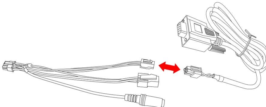
4. Подключите **чёрный провод** (общий) к минусу источника постоянного тока с напряжением 12 ~ 24 Вольт.
