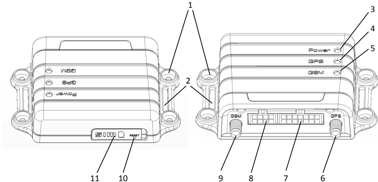
1. Отверстия для крепежа, Ø3 мм
