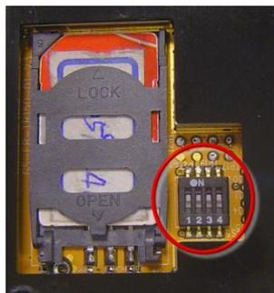
Блок из четырёх DIP-переключателей расположен под аккумуляторной батареей. С помощью них можно задать дополнительные режимы. Для манипуляции с переключателями рекомендуем использовать канцелярскую скрепку.
