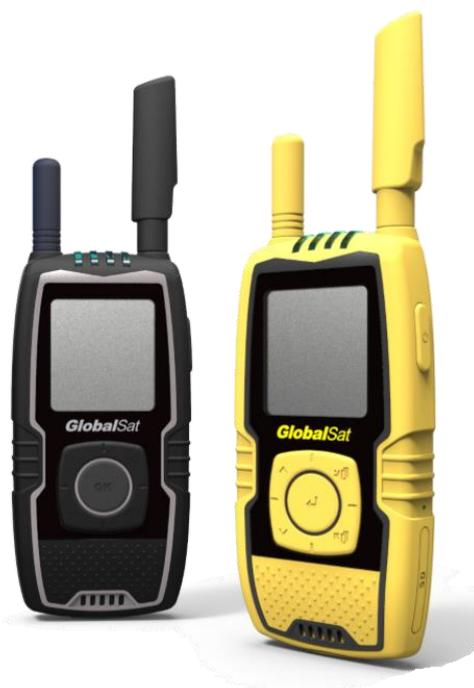
Управляющее устройство которое можно подключить к устройствам (смартфон, ноутбук, планшет) по каналу Bluetooth. **Мобильный терминал** позволяет редактировать (?) текстовые сообщения, которые можно отправлять и получать на трекеры **LoRaLink** и оснащён встроенным приёмников GPS. Так же, **мобильный терминал** выполняет роль **ретранслятора**, тем самым увеличивая радиус работы системы.
