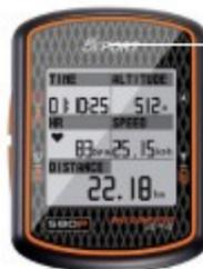
GPS антенна расположена в верхней части устройства. Сохраняйте ее положение направленным вверх для лучшего приема сигнала
