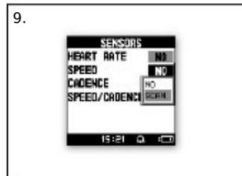
Выберите режим "scan" для синхронизации датчика скорости с GB-580. При завершении на дисплее появится HR вместо SCAN.
