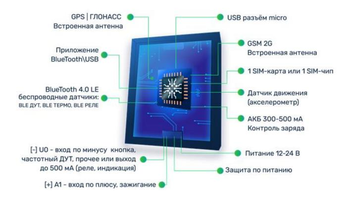
Навигационный контроллер L1 (далее «трекер») - компактное и функциональное устройство, предназначенное для дистанционного наблюдения за подвижными объектами и сбора данных с установленного на них оборудования.
